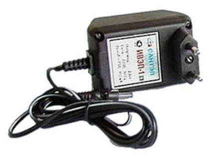
Идивидуальное зарядное устройство для NiMH аккумулятора 10HMГ-1. Время зарядки аккумулятора емкостью 1000 мАч – до 14 часов. Оптимальный режим работы при температуре от +5 до +40°C. Возможен заряд как отдельного аккумулятора, так и аккумулятора, подключенного к радиостатици.
