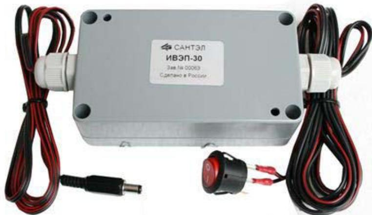
В основе блока питания находится DC-DC преобразователь с широким диапазоном входного напряжения 9-36 В. На выходе блока 13.5 В. Очень важно, что данный блок питания гальванически развязывает потребителя от питающей сети. Данное условие необходимо при использовании портативной радиостанции в качестве стационарной (Например: Гранит 2Р-44 при подключении внешней антенны АВ-41).
